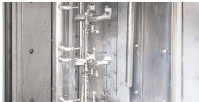
Вид зоны сушки: сушка с системой вращающихся сопел и мощным компрессором бокового канала
