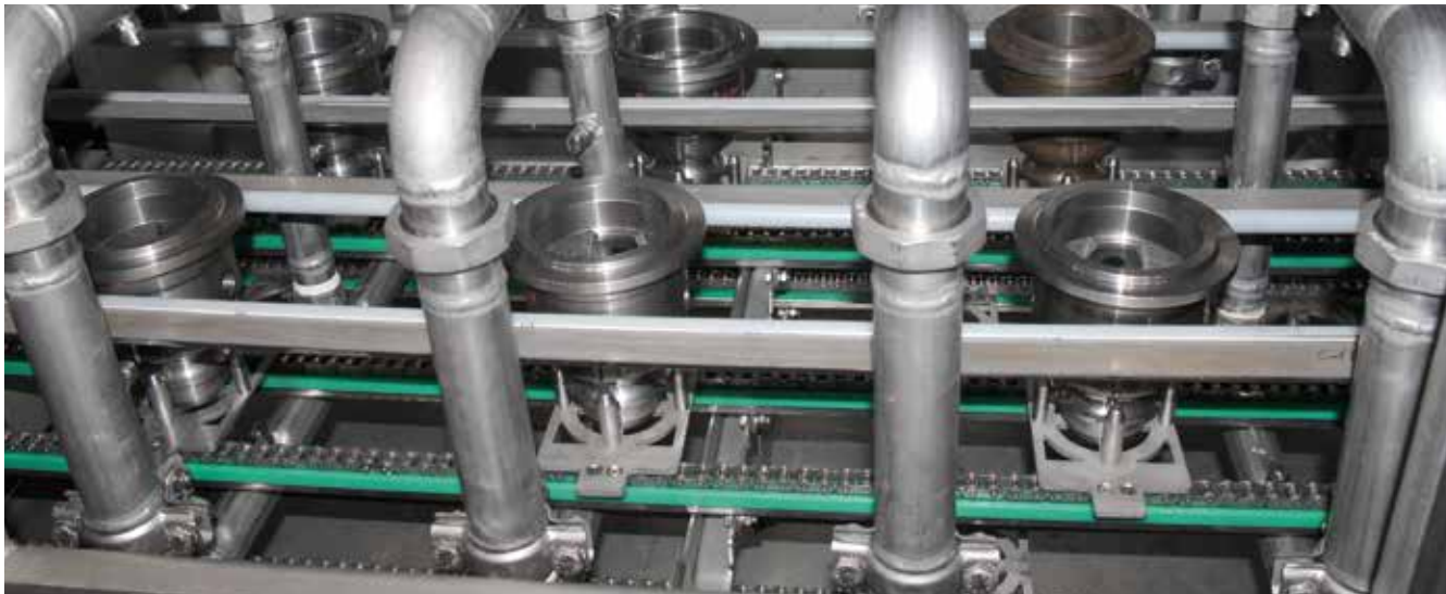
链式输送机 带有螺栓固定的工件架和适配的喷嘴系统
