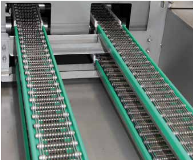
双轨钢丝输送带 用于较小的、不同的工件
